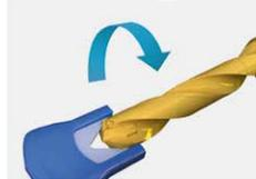
3. Bohrkopf durch drehen im Uhrzeigersinn montieren
