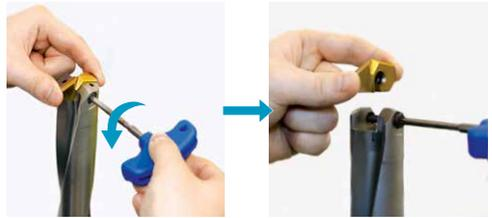
Zum Lösen die Klemmschraube 3- bis 5-mal gegen den Uhrzeigersinn drehen. Die Schraube muss nicht aus dem Körper entfernt werden.
