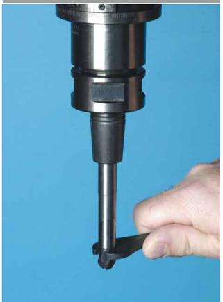
Abb. 4: Fühlerlehre darf NICHT in Verbindungslücke passen
