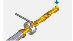
4. Fasring klemmen und Bohrkopf montieren
