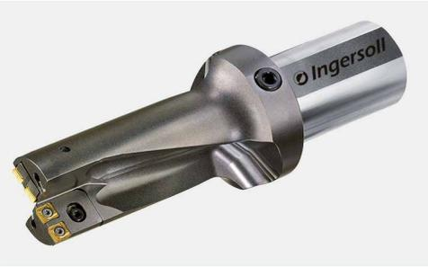
Jeder Wendeschneidplatten-Kassettenvollbohrer deckt einen bestimmten Durchmesserbereich ab. Dieser kann durch das Hinzufügen und Austauschen von Abstimmplatten [4] verändert werden.
