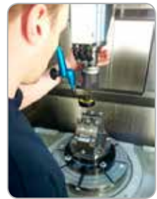
Abb. 37: Prüfen der Rundlaufgenauigkeit
