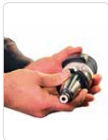
Abb. 30: Beispiel einer Werkzeugaufnahme mit Kühlmittelbohrung
