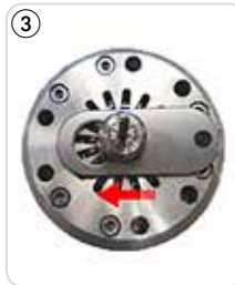
Abb. 33 a/b: Flache Schaftverriegelung aufsetzen und befestigen.
