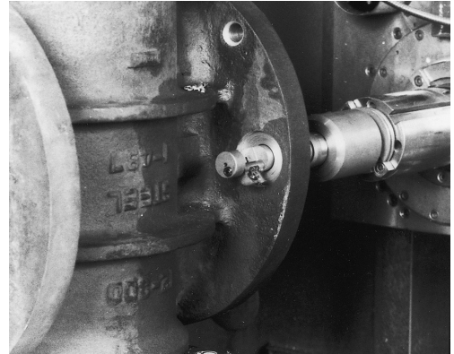
Rückwärtssenken in Groß- Ventil- Gehäuse
