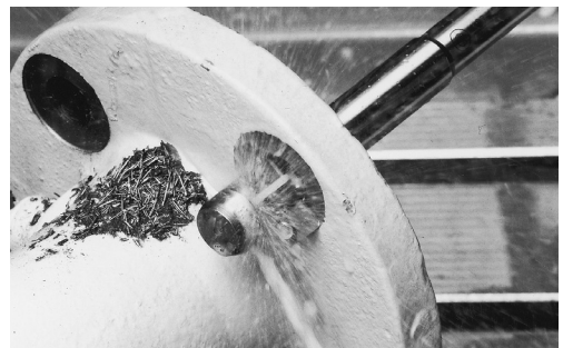
Planen mit Innerer Kühlmittelzufuhr
