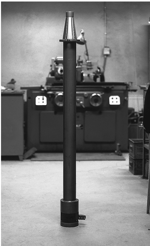
Sonderwerkzeug zum bearbeiten eines Dieselmotorblocks
