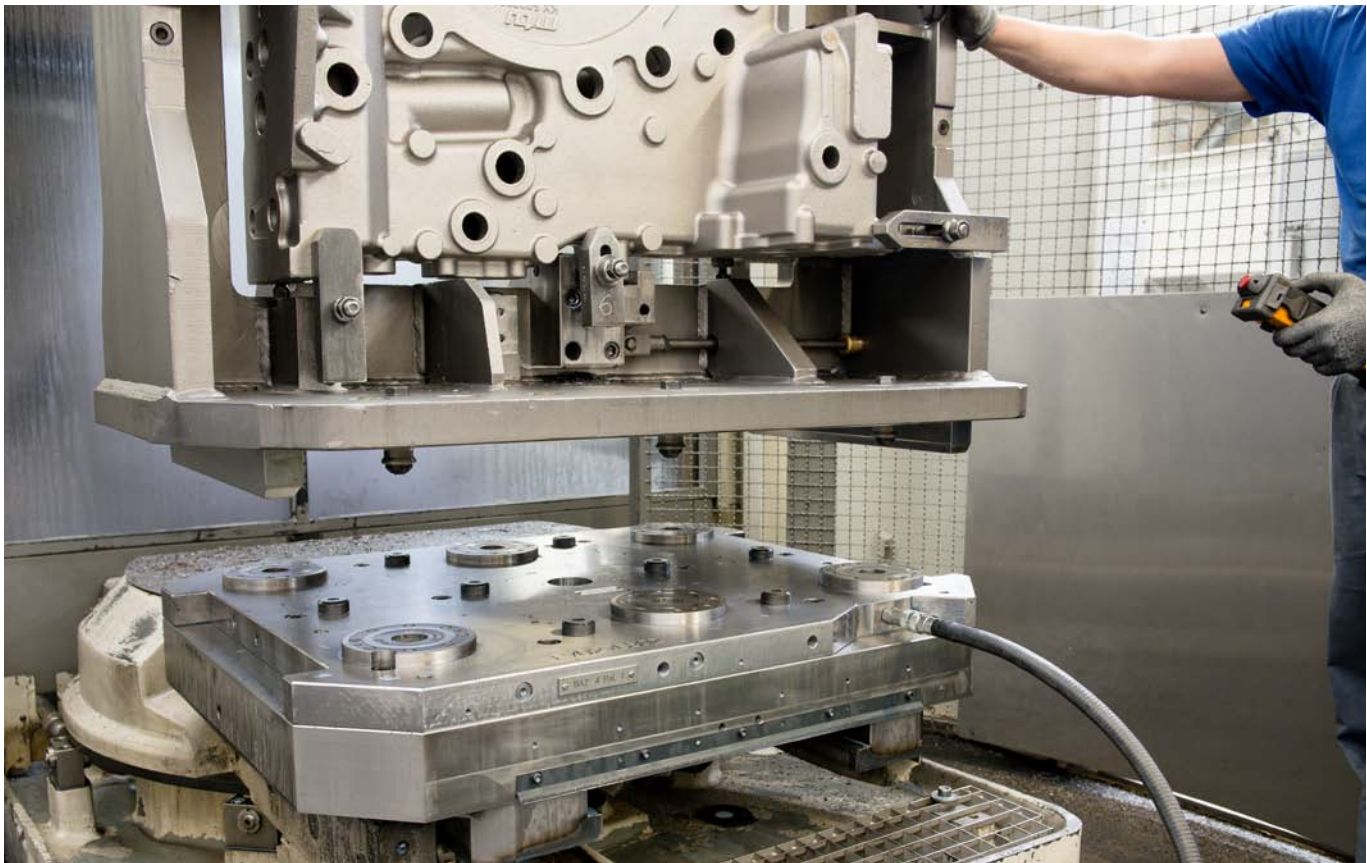
Durch das zwei geteilte Spannbolzensystem mit großem Fangeinzug und dem kugelkäfigfreien Modulaufbau ist ein ergonomischer Vorrichtungswchsel verkantungsfrei möglich.
