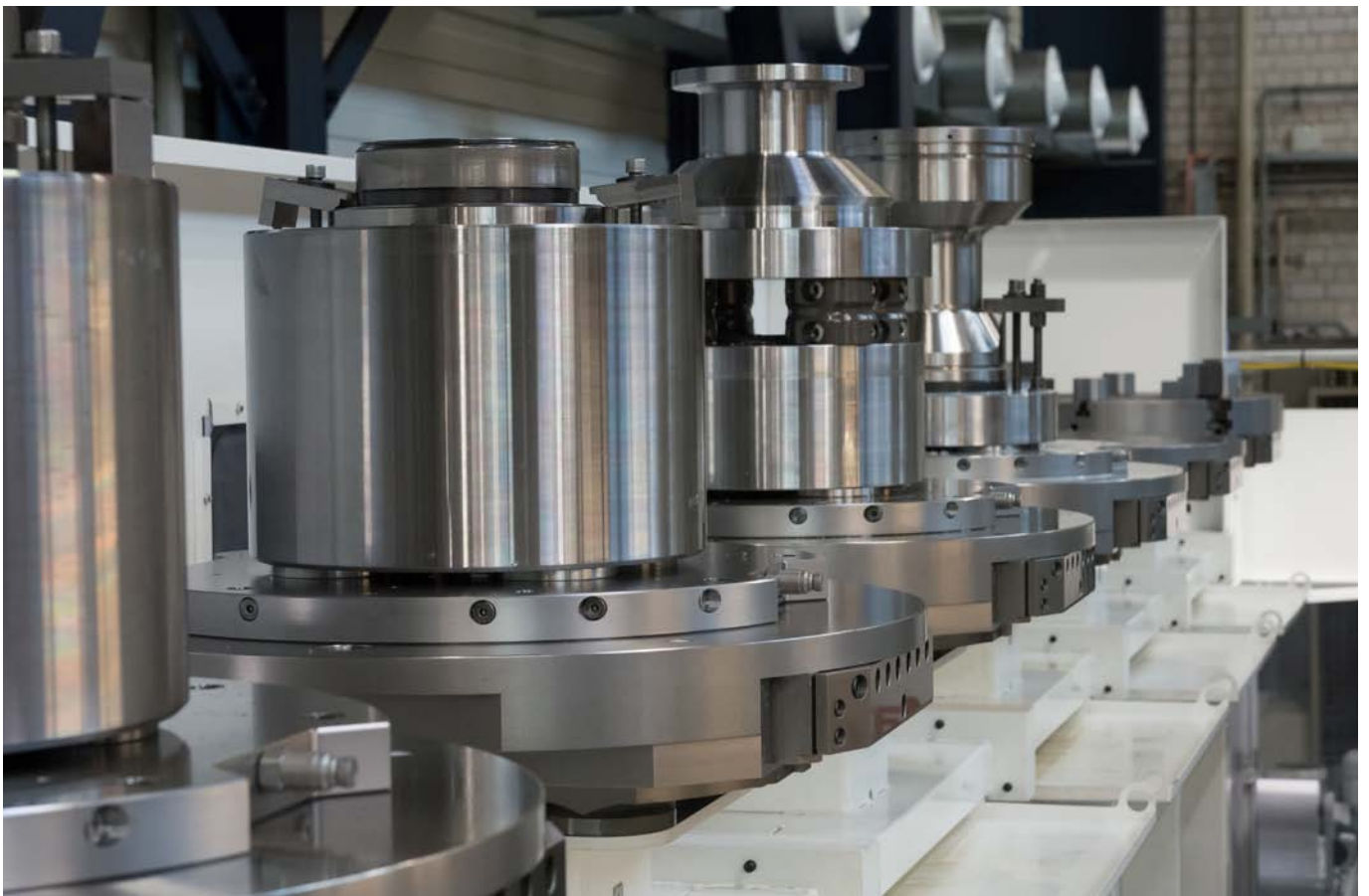
AMF-Nullpunktspannsystem im Einsatz auf einem Fräs-Drehzentrum mit Palettenbahnhof. Das Zero-Point-System bildet hier die einheitliche Schnittstelle auf allen Maschinenpaletten.
