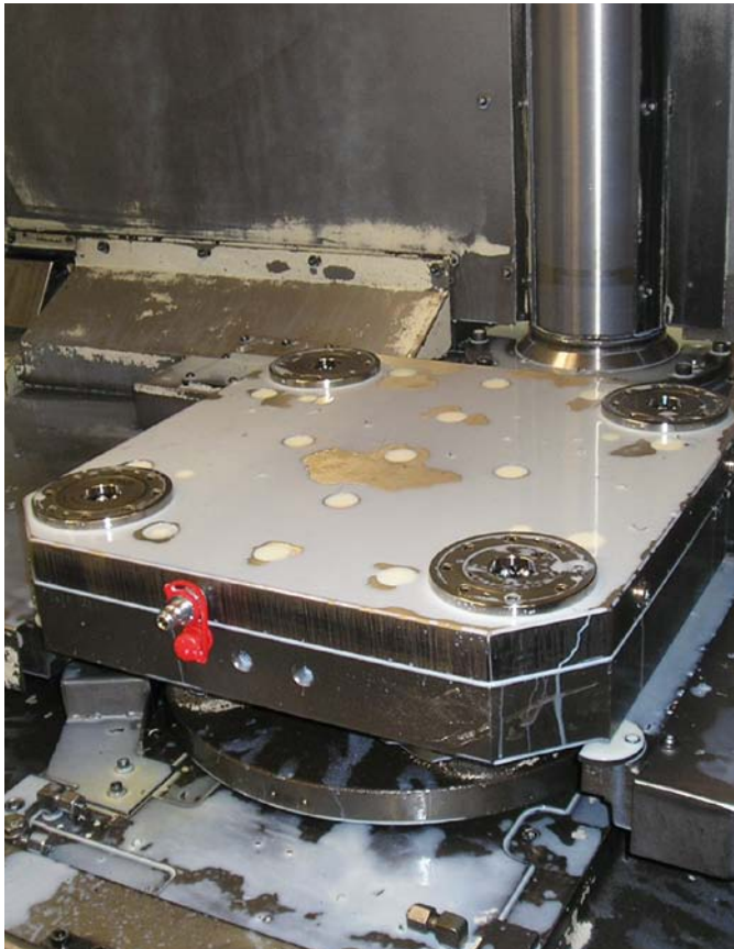
Der Innenraum der Spannmodule ist komplett abgedichtet. Dadurch ist das System vor Flüssigkeiten und Schmutz bestens geschützt.
