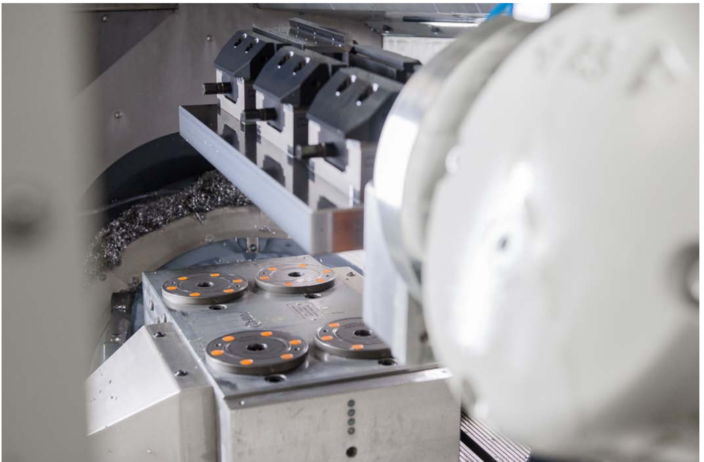
Vielseitige Abfragemöglichkeiten und zuverlässiger Halt bei hohen Handlingsgewichten gewährleisten eine nahtlose Integration in die automatisierte Roboterbeladung sowie der anschließenden Bearbeitung.
