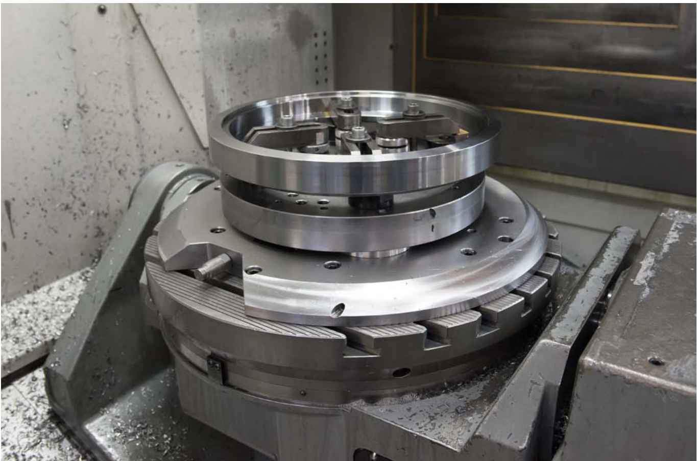
5-Achs-Bearbeitung von Maschinenbau-Komponenten. 4-fach-Spannstation mit individueller Außenkontur für maximale Zugänglichkeit.
