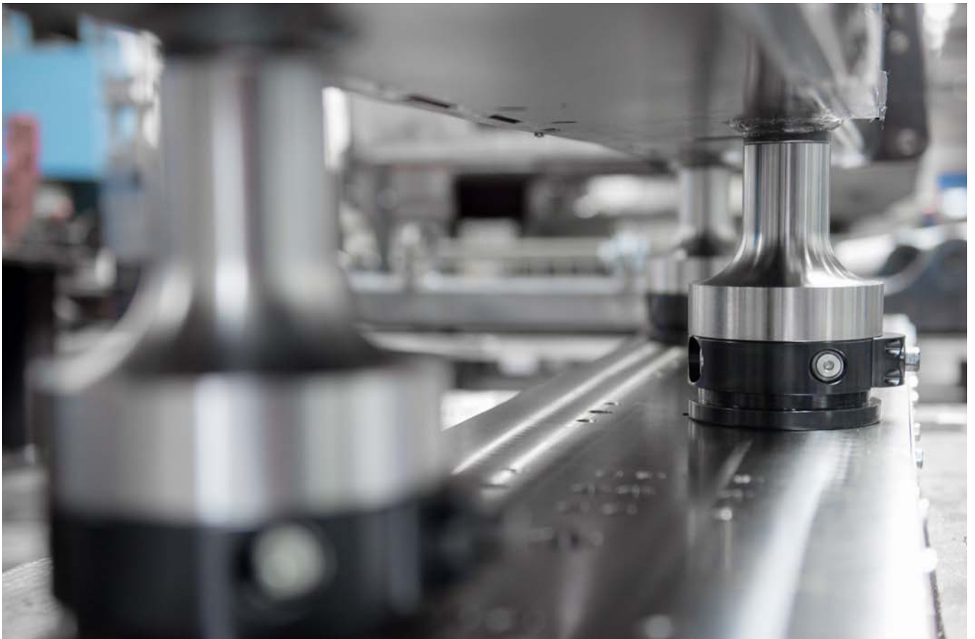
Rüstzeitoptimierung in der Kleinserienfertigung durch eine variable Bauteildirektspannung. Die Doppel-Spanmodule können durch einfaches Umpositionieren an verschiedene Bauteile schnell angepasst werden.
