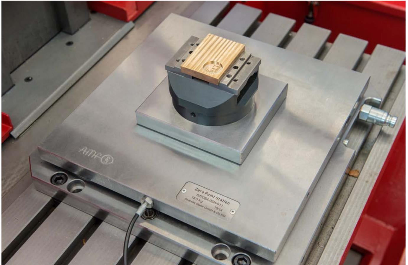
Le Zero-Point-System d'AMF constitue l'interface unique entre plusieurs machines. Ainsi, la pièce peut être serrée en un temps record sur les différentes tables machines, indépendamment de la taille.
