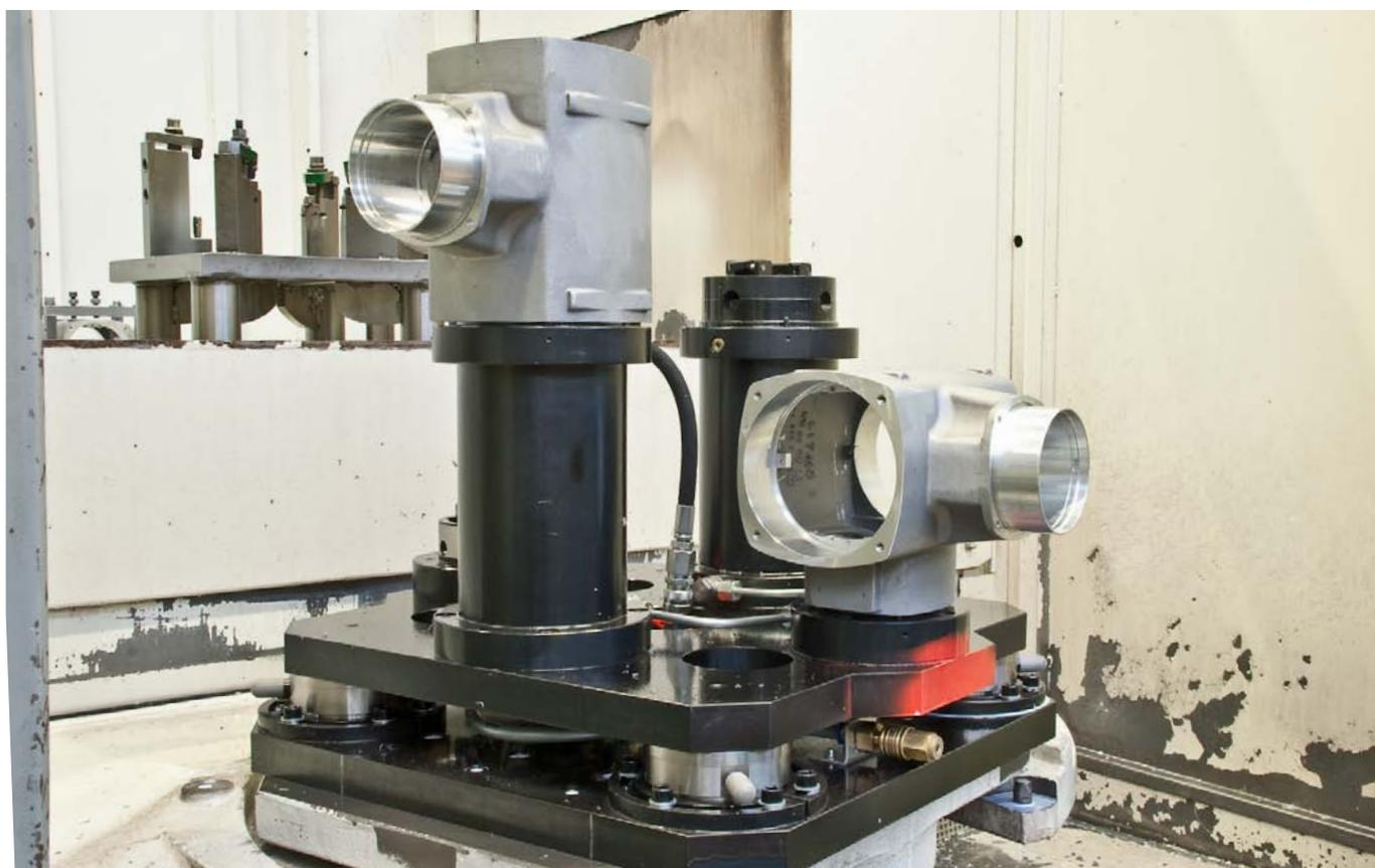
Modules de serrage à poser en association avec les systèmes de bridage hydrauliques d'AMF dans un centre d'usinage.
