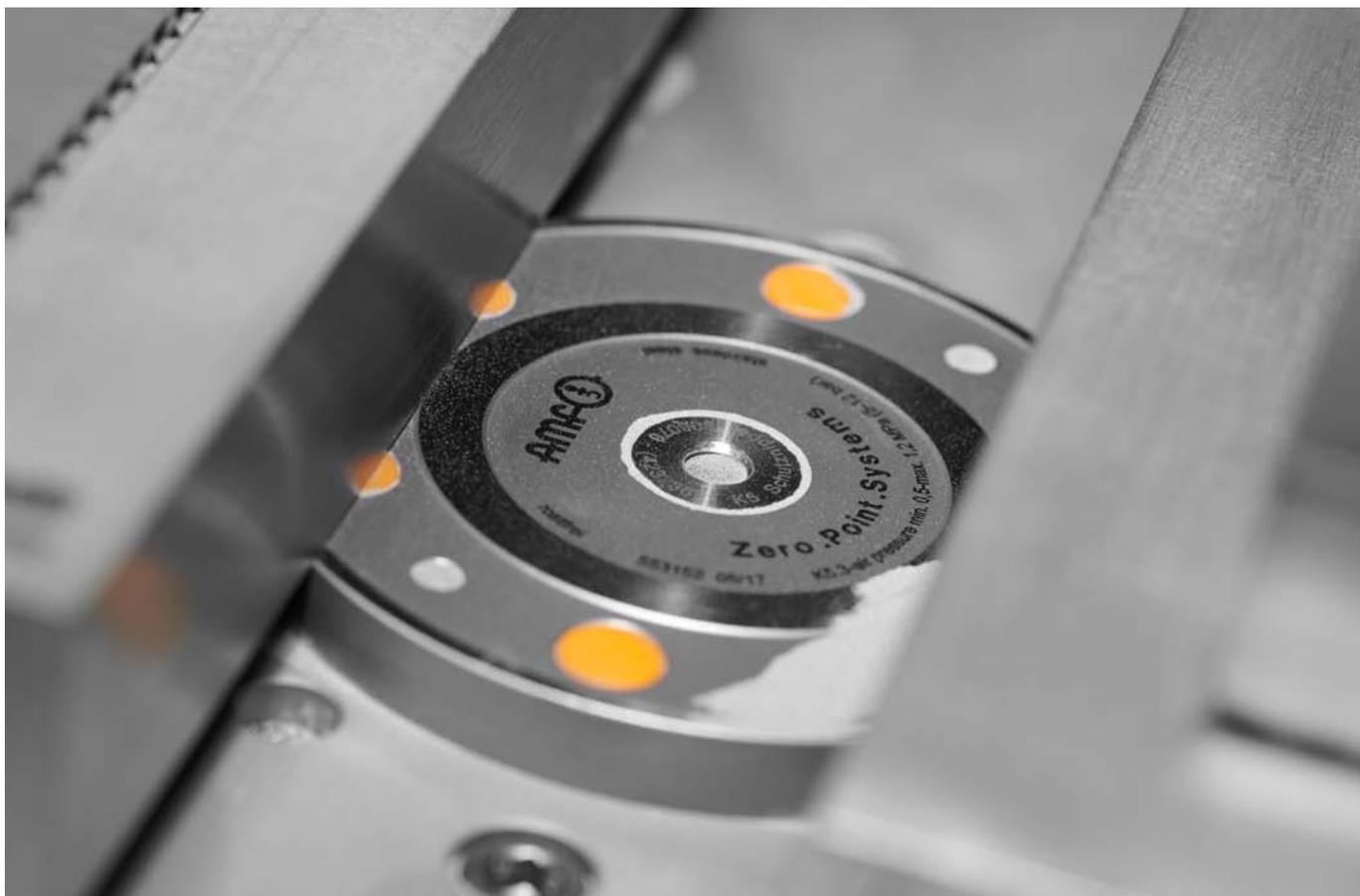
Les modules de bridage point zéro AMF sont spécialement conçus pour l'utilisation dans la fabrication additive et les influences de température élevées qui en résultent. Ils sont complètement étanches et ainsi non sensibles aux actions de la poudre métallique.
