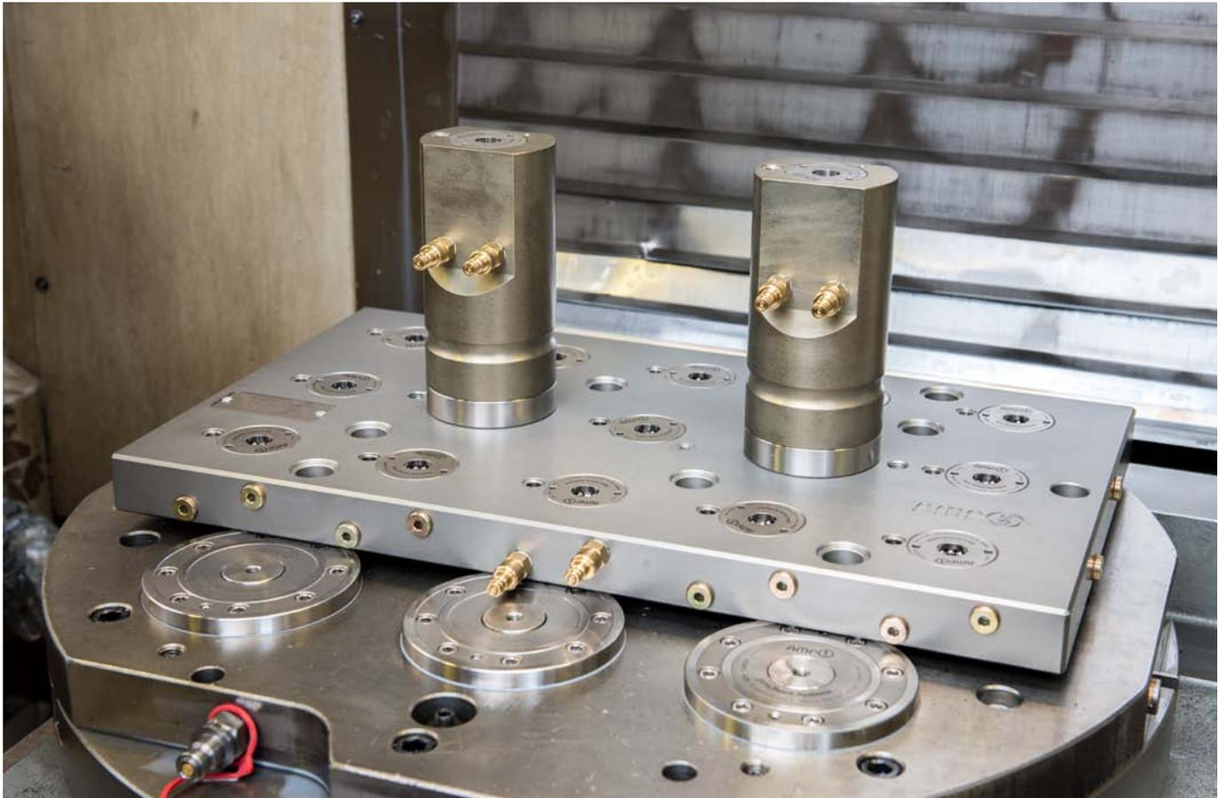
Usinage des 5 faces au moyen de consoles de serrage pour le serrage direct des composants.
