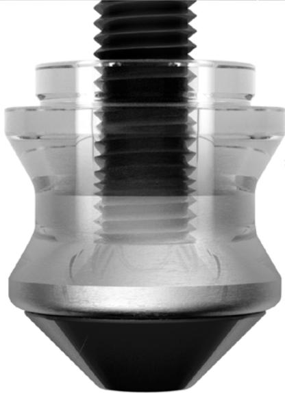
> Dans notre système «Zero-Point», la tirette de centrage est l'interface entre la table de la machine et la pièce ou l'outillage. Elle garantit une position précise et un bridage sûr. Elle transmet également à la table via les modules, les efforts d'usinage générés.
