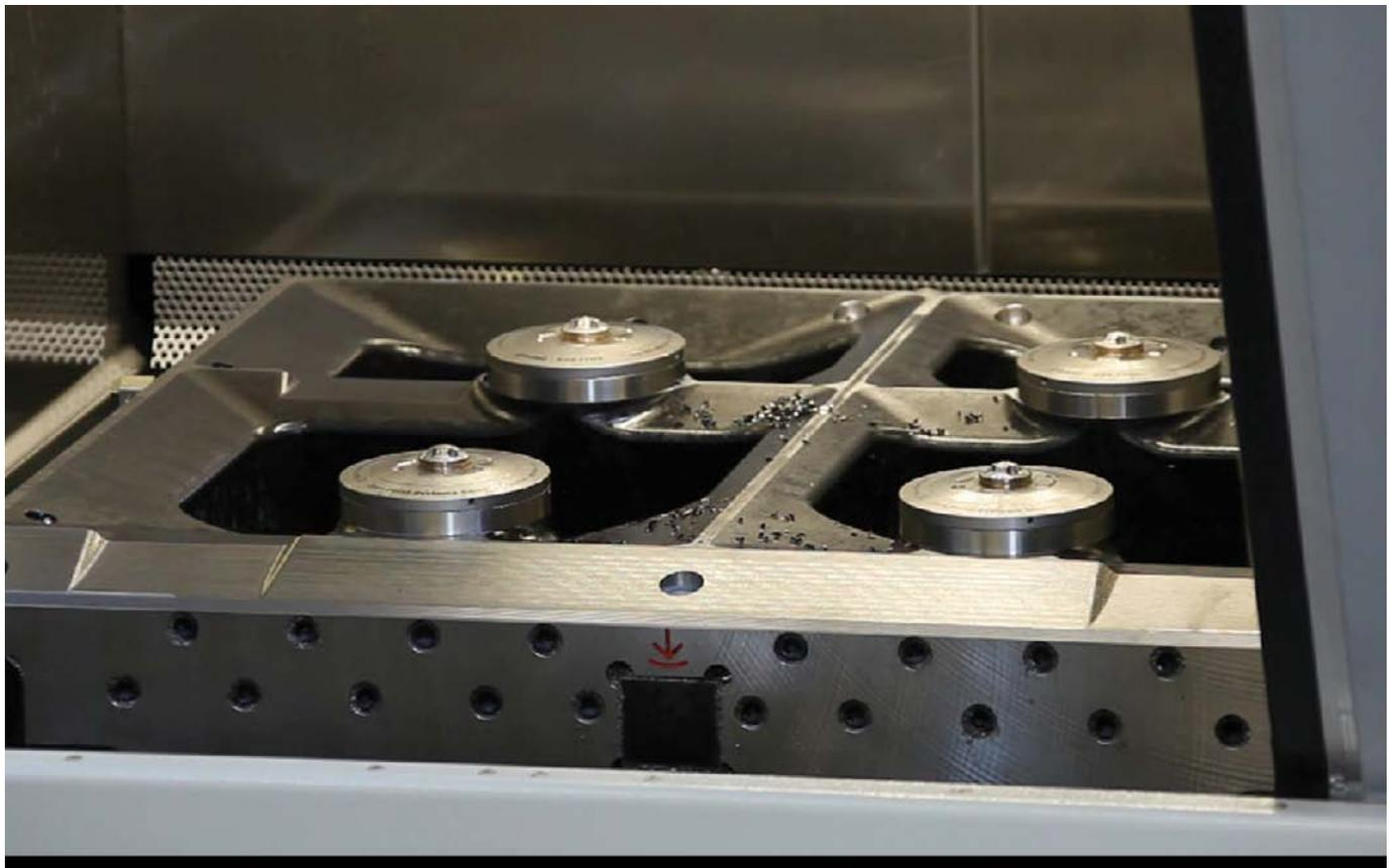
Module de serrage High-End « Turbine » utilisé dans un processus de fabrication totalement automatisé avec chargement robotisé.
