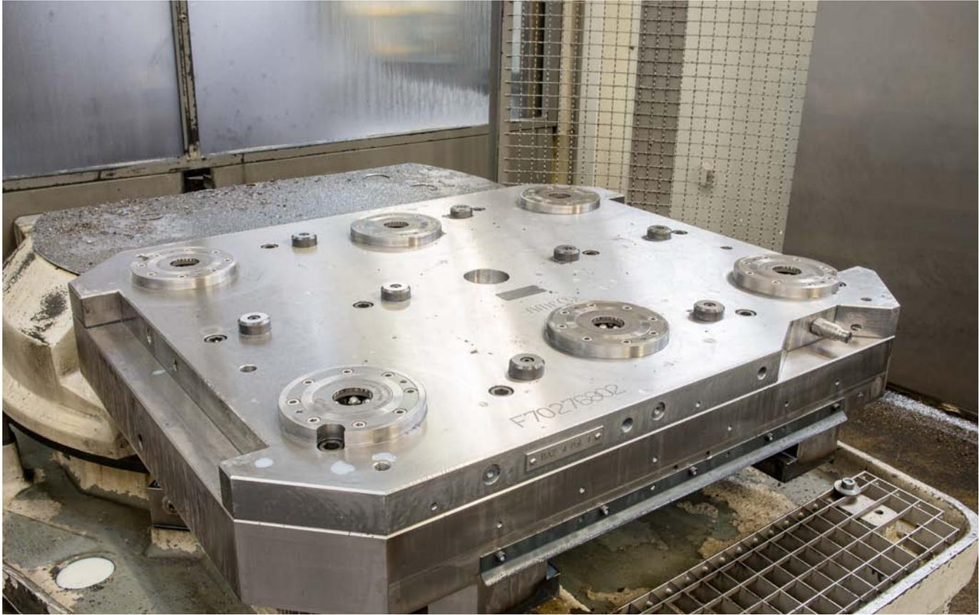
Technique de bridage du point zéro en application dans la fabrication de gros moteurs.
