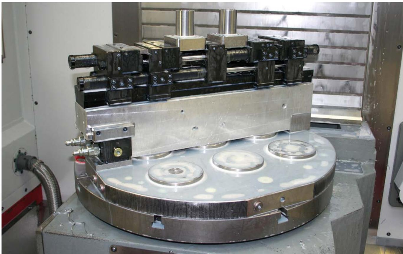
Étau hydraulique pour l'usinage de plusieurs pièces, même différentes, en un serrage – sur le Zero-Point-System d'AMF.
