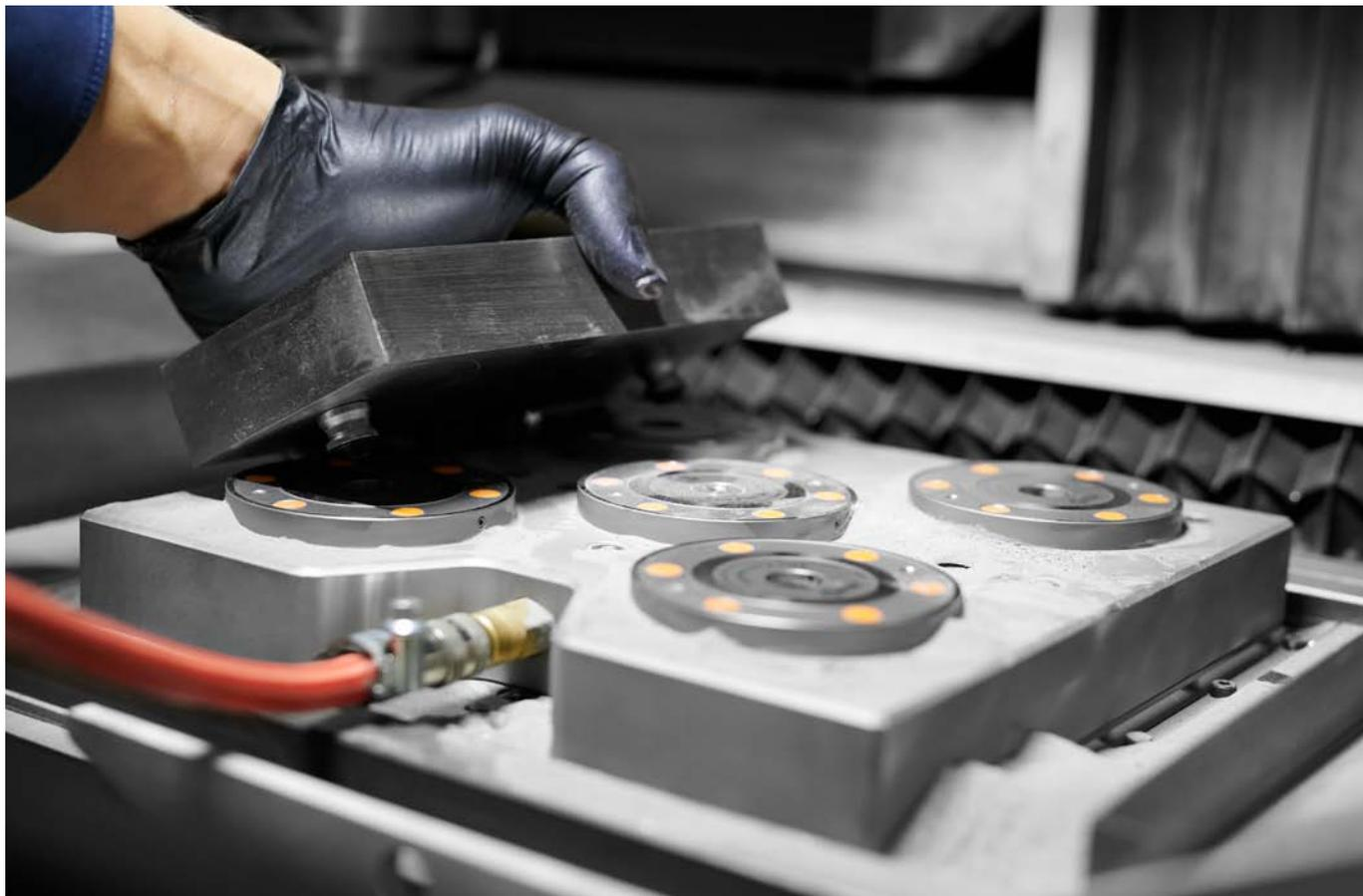
Zero-Point-Systems AMF pour la fabrication additive.
