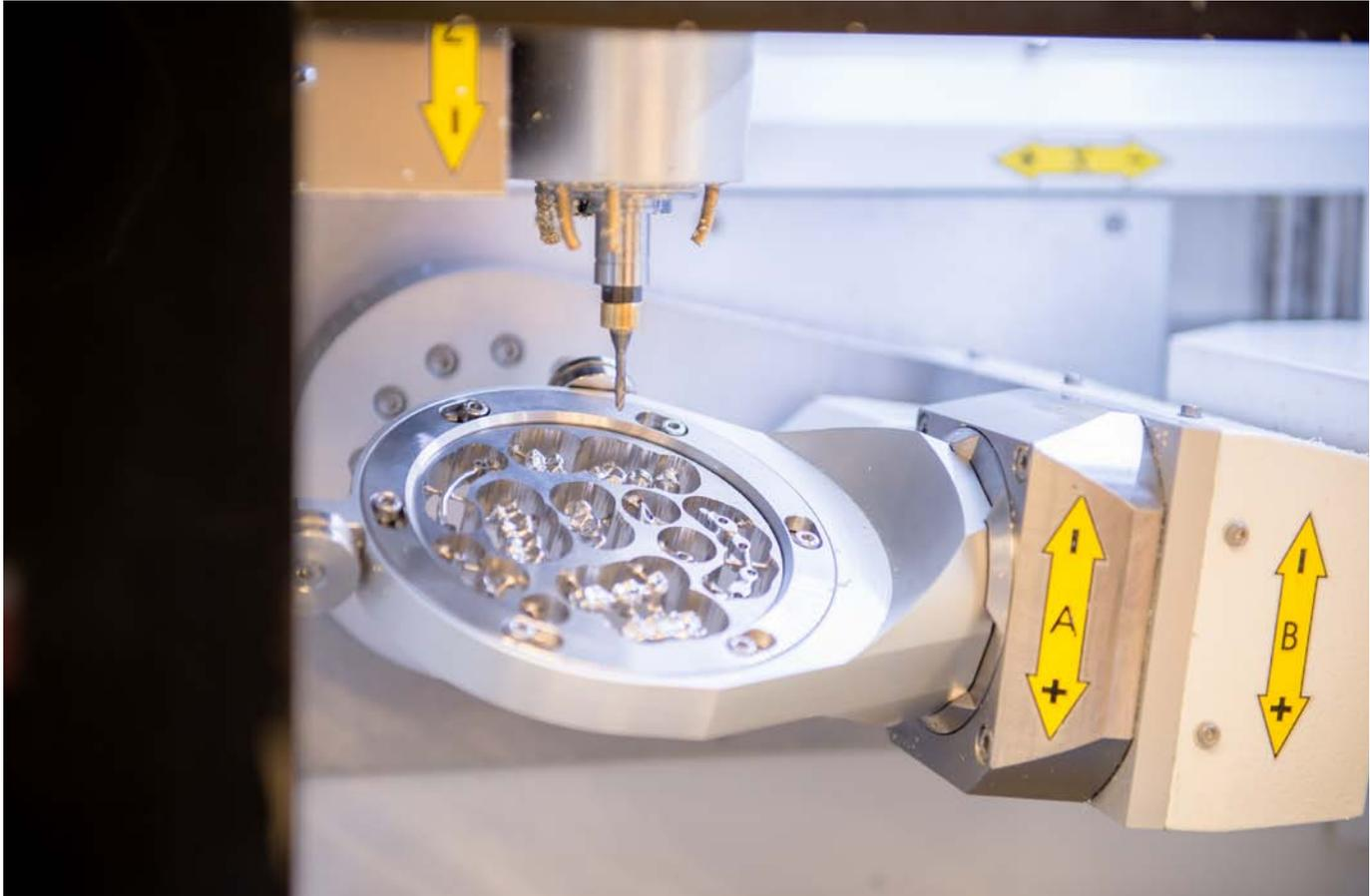
Chargement et serrage totalement automatisés de rondelles lors de la fabrication d'implants dentaires.
