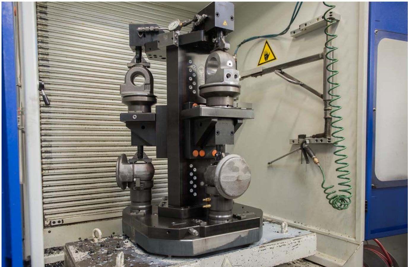
Cette solution complète de serrage rassemble plusieurs types de serrage en un dispositif de serrage (système de bridage modulaire, systèmes de bridage hydrauliques et technique de bridage du point zéro).
