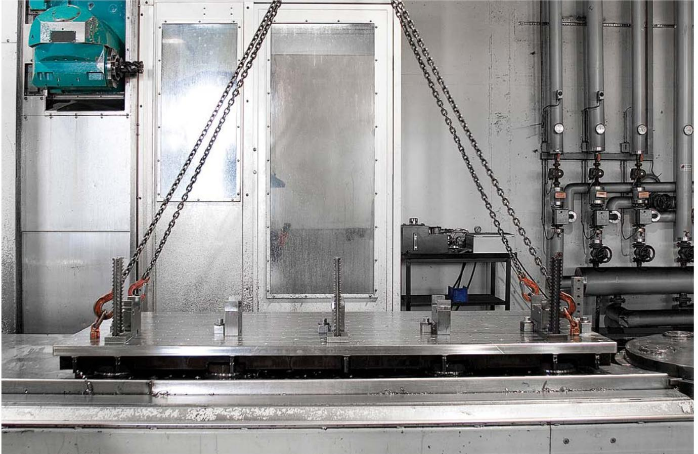
La structure cylindrique des goujons de serrage ainsi que le logement dans le module de serrage garantit un équilibre des tolérances en hauteur et en longueur même sur de longues distances.
