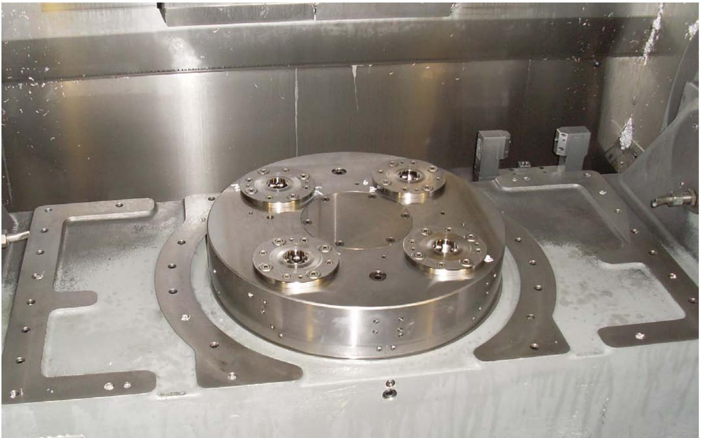
Solution d'automatisation avec contrôles de verrouillage et d'appui ainsi qu'extraction de goujon de serrage utilisée dans un processus de fabrication totalement automatisé avec chargement robotisé.
