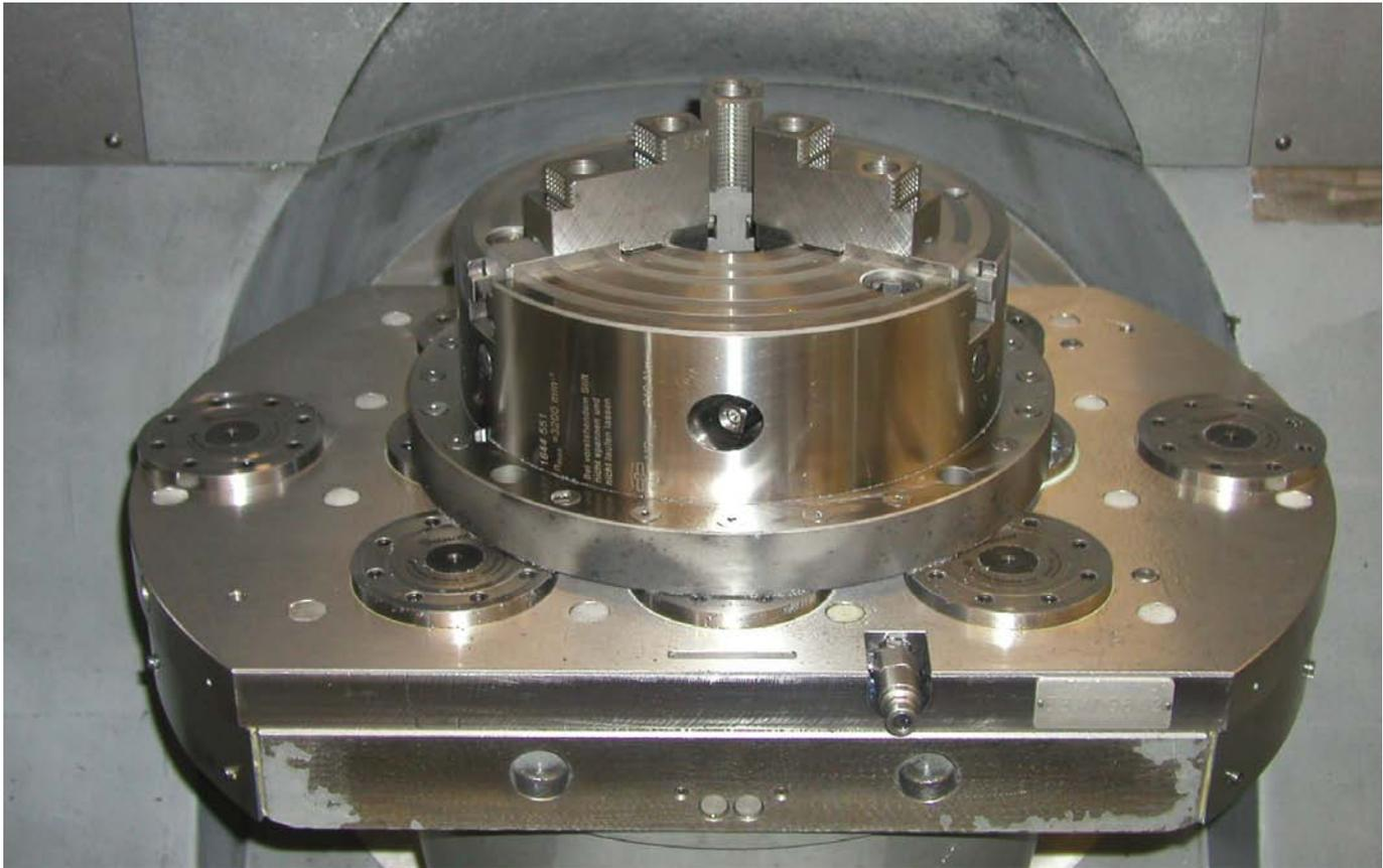
Changement simple d'un mandrin à 3 mors au moyen du Zero-Point-System d'AMF.
